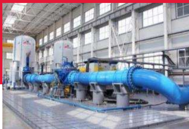
Стенд испытаний горизонтальных насосов и агрегатов
